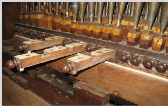
Abb. 61: Stade St. Cosmae & Damiani. Berendt Hus und Arp Schnitger. 1668-1688. Mechanische Springlade (Oberwerk).
