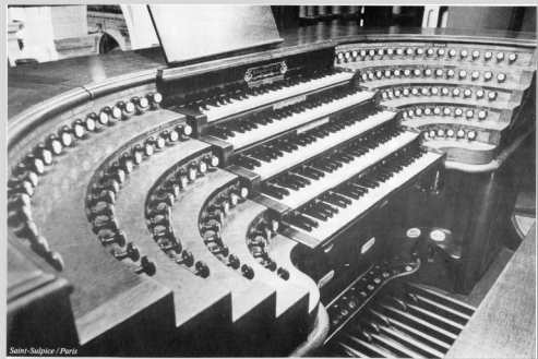
Abb. 55 (siehe auch Abb. 67 ): Paris. St. Sulpice (V/P./100). Aristide Cavallé-Coll. 1862. Mechanischer Spieltisch mit Barker-Hebel-Technik.
