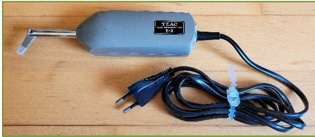
Abb. 1 Entmagnetisierungsdrossel für Tonköpfe (TEAC)
